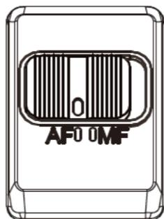
如果需进行自动对焦操作，请将镜头 AF/MF 的转换开关设置为“AF”模式。
